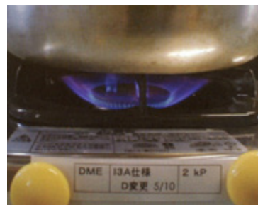
民生用（家庭用など）コンロによるDMEの燃焼 （都市ガス・13A使用、ダンパー開度 5/10）
