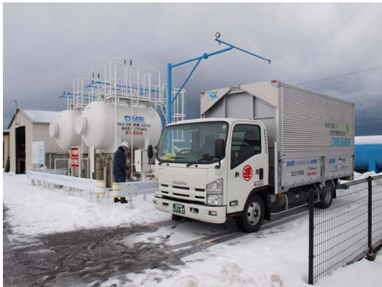
新潟市西区黒鳥 東邦アーステッククロサキ事業所ない充填スタンドで充填する新潟運輸DMEトラック
